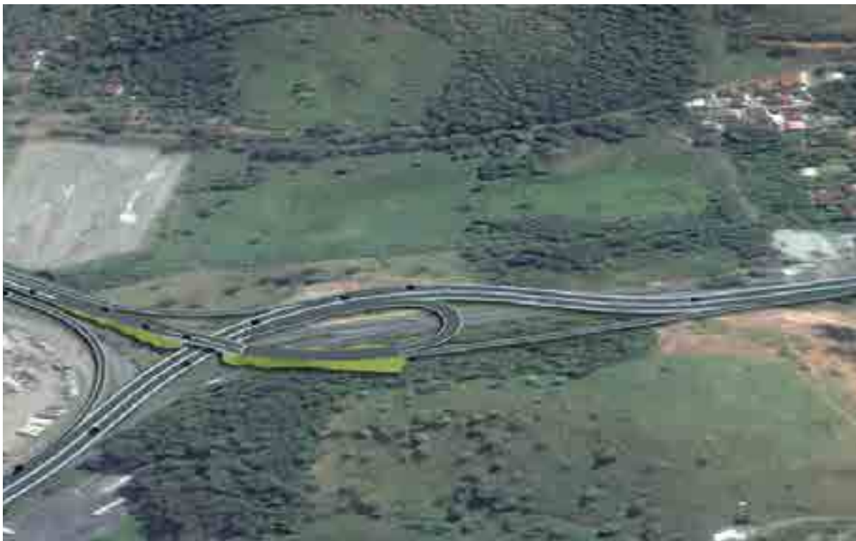
O viaduto do entroncamento das duas BRs (101 e 262) contará com níveis diferentes de passagens, facilitando o fluxo de veículos
